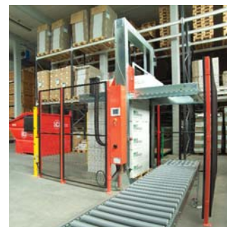
Nella versione semiautomatica premendo un pulsante tutto il livello viene trasferito sul bancale.
