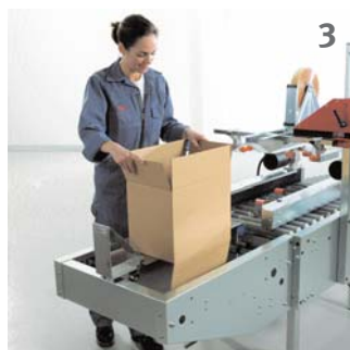
La scatola viene abbassata sul binario e tirata indietro; i lembi laterali vengono richiusi.
