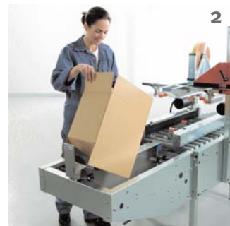
Il lembo anteriore e quello posteriore vengono ripiegati dal binario.
