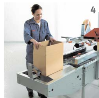
La scatola viene mantenuta in sede ed è pronta per il riempimento.
